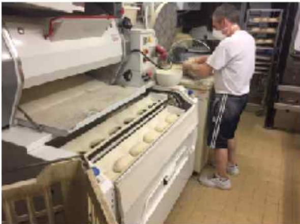
*Le boulanger pèse la pâte et la met en forme de boule, puis il la met dans cette machine qui donne la forme de la baguette.*
